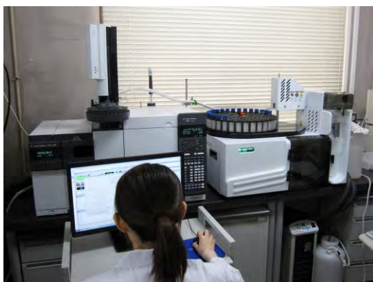
ページ・トラップーガスクロマトグラフィー質量分析装置 (臭気物質検査)
